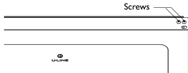
Top Of Door
